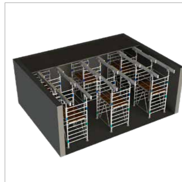
- Escoramento para lajes pré-fabricadas alveolares AL200 com torres A120.
